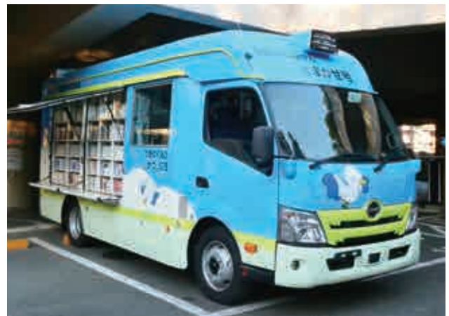
五代目はまかぜ2号(2022年4月～) 日野デュトロ(3.5t)を改造(積載量3000冊) 車体のマスコットキャラクターはマグネット製で着脱可能
