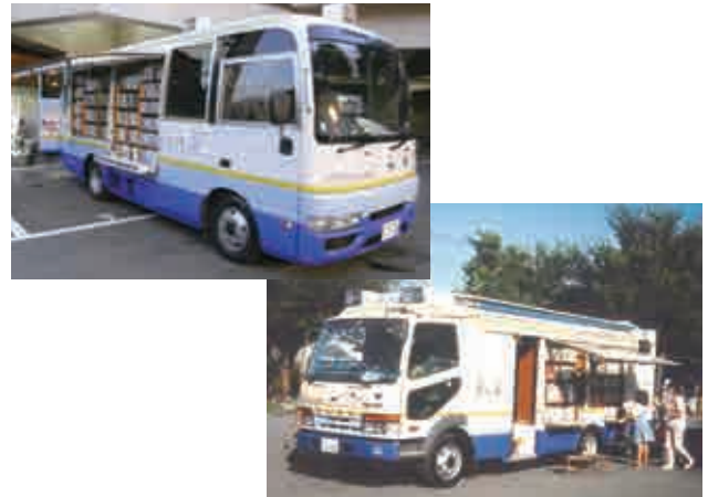
左:四代目はまかぜ1号(2005年～2016年) 日産シビリヤン(26人乗りマイクロバス)を改造(積載量3500冊) 右:四代目はまかぜ2号(1998年～2006年) 三菱ふそうKC-FK727(4.6tトラック)を改造(積載量3500冊)
